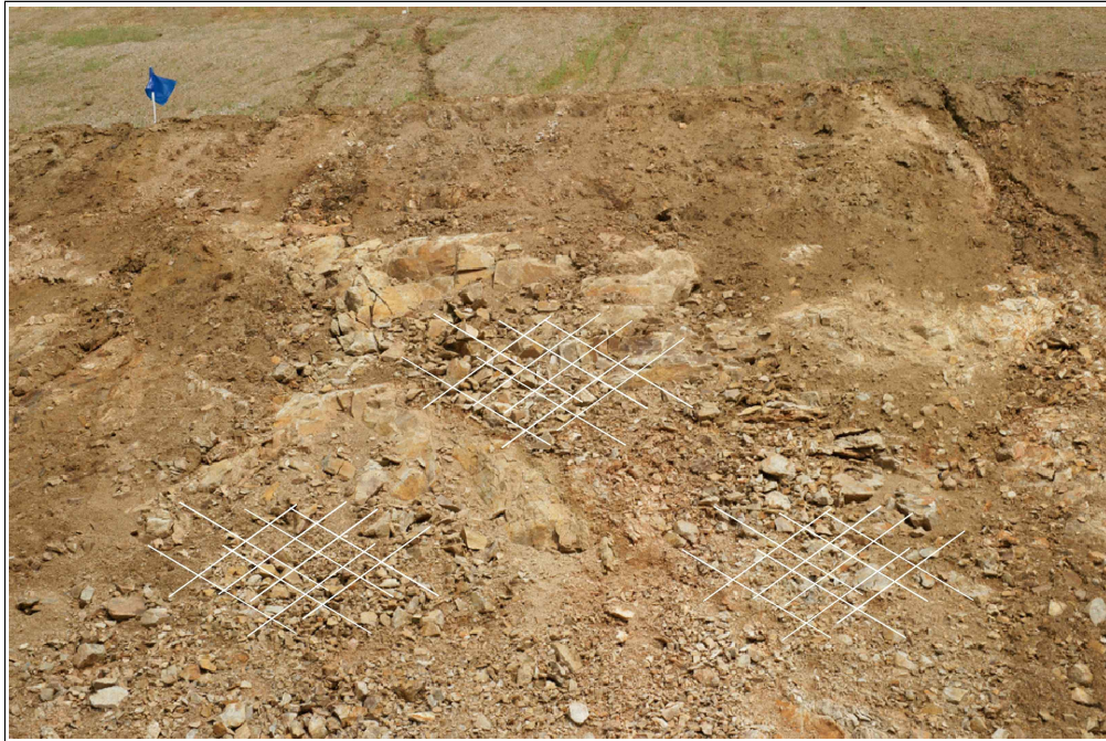
【그림 23】 B 영역 상세사진 (세편화된 암석)
